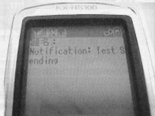
〈写真 7〉XPort からのメールを PHS で受信した様子
