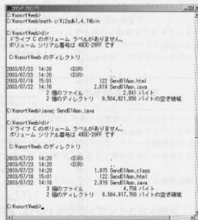
〈図30〉PATHの設定からコンパイルまでを実行したようす
