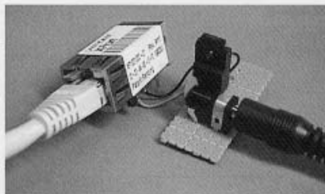
〈写真4〉電源回路を接続したようす
